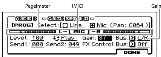
**Achtung:** Idealerweise sollte sich das Meter um die 70% herum bewegen. Wenn das Eingangssignal übersteuert, „leuchtet“ die [MIC]-Anzeige. Am besten speichern Sie diese Einstellung, um sie nicht zu verlieren. (Siehe „Globale Audio-Einstellungen ‚G-SET‘ und einzelne Parameter“ in der Bedienungsanleitung.)
