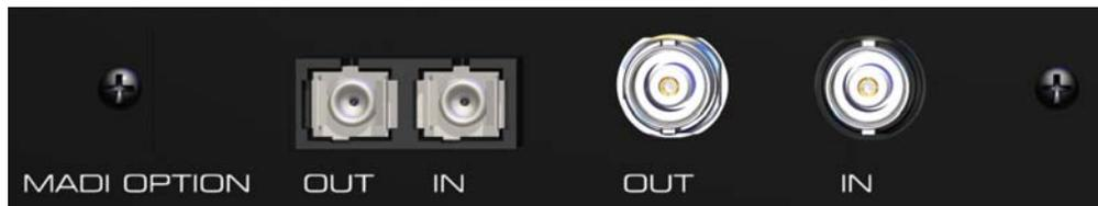
Der MADI Eingang dient einerseits als optionale Clockquelle (Sektion Clock, OPTN), aber auch als Durchschleifeingang. Da der Micstasy nur 8 Kanäle belegt, schleift die I64 MADI Card bis zu 56 Kanäle durch.
