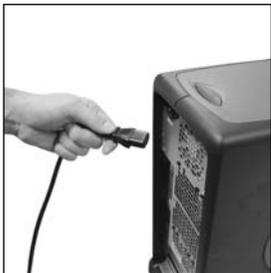
1. Schalten Sie den Computer ab. Achten Sie unbedingt darauf, dass der Netzschalter ausgeschaltet ist, und trennen Sie das Stromkabel vom Computer.
